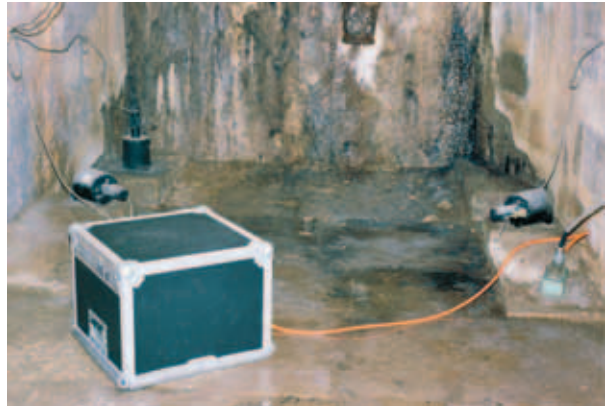
A l'esquerra, esquema del funcionament d'un sismògraf. A la fotografia de la dreta es mostren els sensors instal·lats a l'antic molí del monestir, els quals, tot i ser de la darrera generació, es basen en el mateix principi (el principi d'inèrcia).
